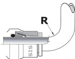
IL RAGGIO DI CURVATURA E' IL MINIMO POSSIBILE AMMESSO DAL TIPO DI TUBO USATO IN QUANTO NON INFLUENZA LA TENUTA SUL RACCORDO. INFATTI L'ANELLO DI SGANCIO E' SEPARATO DALL'ANELLO DI BLOCCAGGIO E L'O-RING E' PROTETTO IN APPOSITA SEDE.
